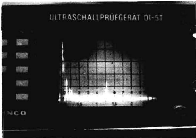
Bild 1. Bildschirmanzeige des Ultraschallprüfgeräts DI-5 T beim Nachweis eines Risses der Laufschienen des Melkkarussells M 693-40
