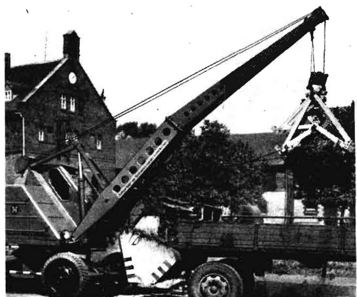
Bild 2. T 172 beim Laden von Stallung auf Mehrzweckanhänger mit angebauter Streueinrichtung
