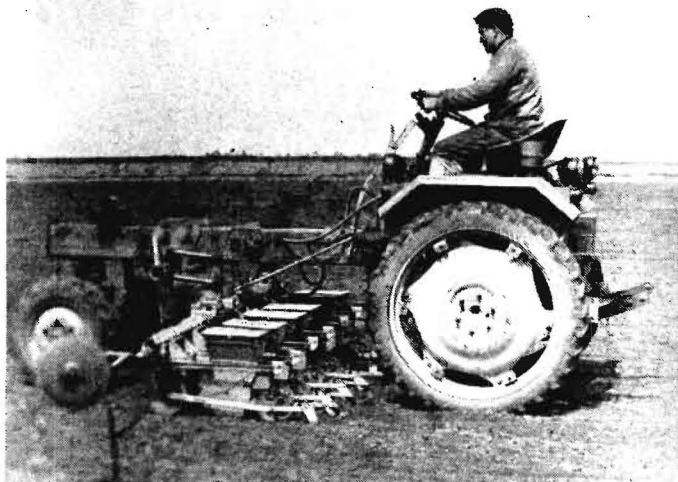
Bild 1. Einzelkornsämaschine A 765 für den Zwischenachs-anbau am RS 09 Bild 2. Einzelkornsämaschine A 695 für den Heckanbau
