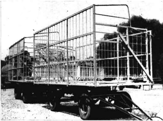
Bild 2. Anhänger THK 5 mit speziellem Strohaufbau SA 29 (Foto: Kotte)
