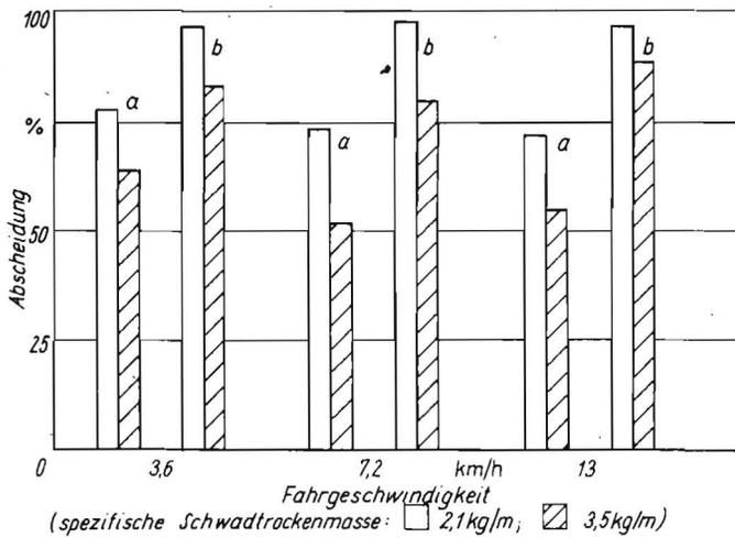
Bild 1. Steinabscheidung der Schwadaufnahmetrommel in Abhängigkeit von der Lage der Steine, der spezifischen Schwadrockenmasse und der Fahr- geschwindigkeit;
