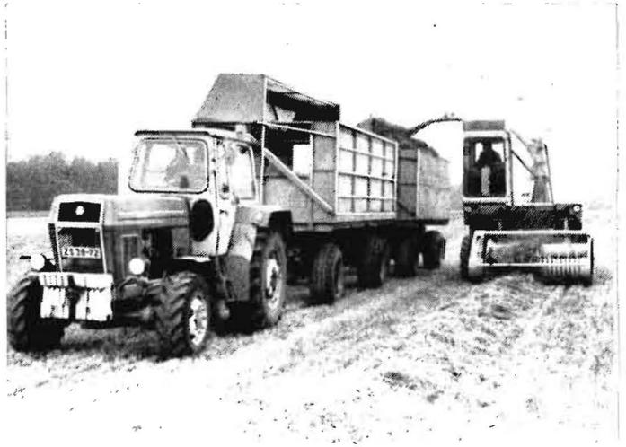
Bild 3. Funktionsmuster volumenvergrößerter Anhängeraufbauten bei der Beladung durch Feldhäcksler (Foto: Kotte)
