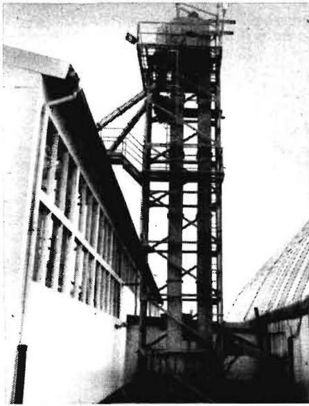
Bild 5. Becherwerk, Becherwerksentleerung, Gittermast, Wartungsbühnen und Trogkettenförderer
