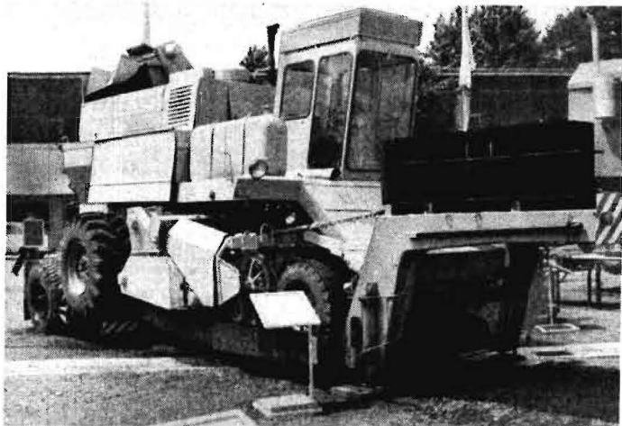
Bild 1 Spezialfahrzeug für den Transport von Rübenrodeladern KS-6; auf Basis eines Tiefladers TL 20, hydraulisch vollständig absenkbar, Spillmotor, Jelcz-Sattelaufleger als Zugfahrzeug, Transportgeschwindigkeit 40 km/h, Gesamthöhe rd. 3,90 m
