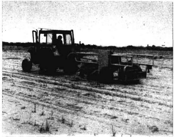
Bild 2. Nichtselektive Grünspargelerntemaschine (Foto: U. Wiesner)
