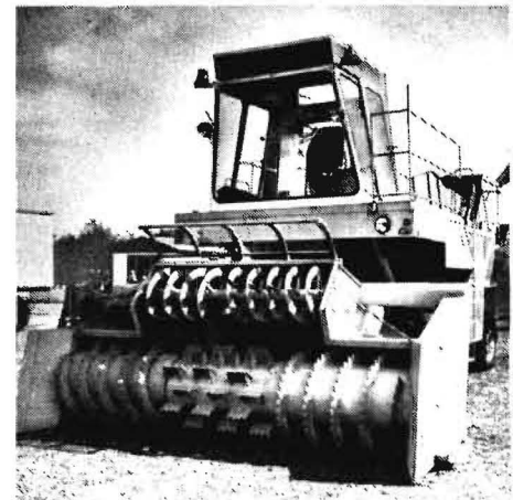
Bild 4 Seitenansicht der selbst-fahrenden Kompostauf-bereitungs-maschine KF 78
