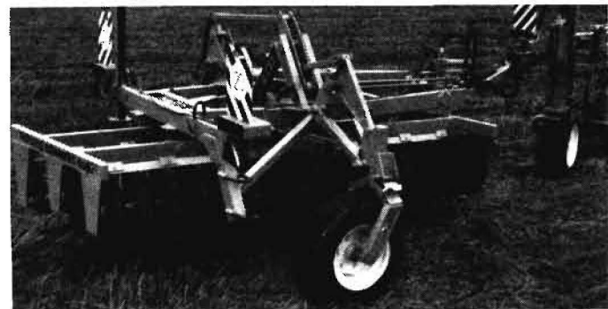
Bild 1. Erstaussführung des Saatbettbereitungsgeräts B 601 mit Linsenpackern und Stabkrümmern
