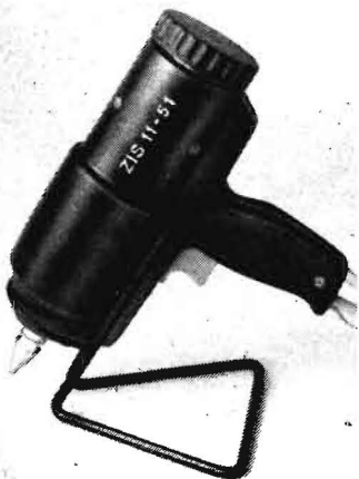
Bild 1 Funktionsmuster der Auftragspistole ZIS 11-51
