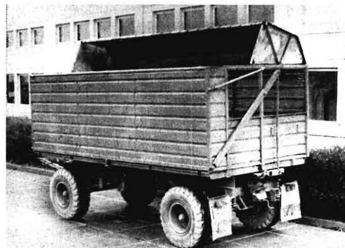
Bild 4 EAS: Kombination Futteraufbau mit Überblasschutz
