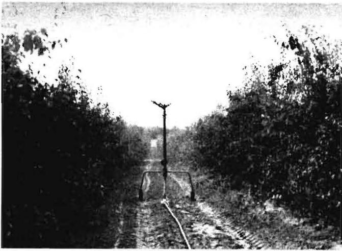
Bild 3. Schlittenstativ für die Streifenberegnungsmaschine PP 67 mit Verlängerungselement zur Überkronenberegnung von Apfelniederstämmen
