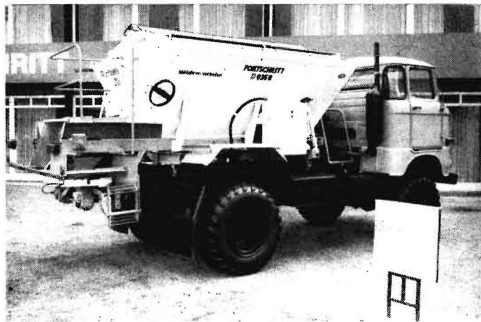
Bild 1 Seitenansicht des LKW W 50 mit Streuaufsatz D 035 B
