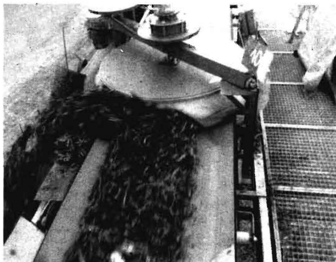
Bild 1 Bürstenabgabeeinrichtung bei der Abgabe von Maissilage mit einem Massedurchsatz Q = 25,2 \text{ t/h}
