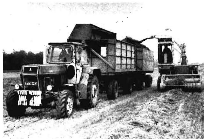
Bild 5. Transporteinheit ZT 303 + 2 HW 80.11/EAS 5 (Ladevolumen 50 m 3 ) für den Transport von Stroh, Frisch- und Welkgut
