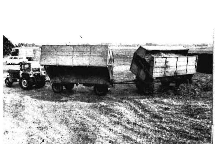
Bild 6. Transporteinheit ZT 303 + 2 HW 80.11/EAS 5 beim Entladen im Silo
