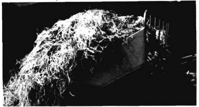
Bild 4. Gefüllte Schaufel des Heckhebers HH 250
