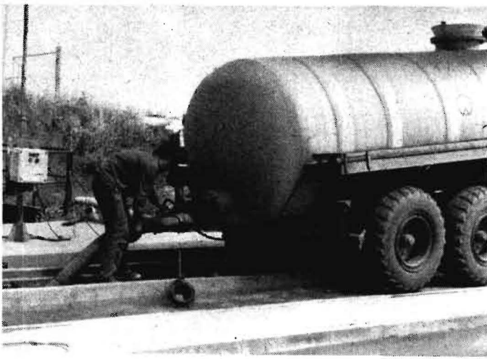
Bild 4. Befüllrichtung mit Kupplung am hinteren Auslaufstutzen (System Berstedt)
