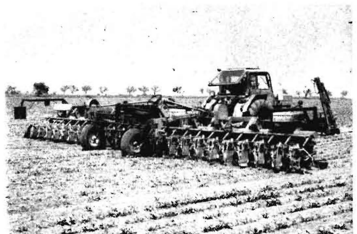
Bild 8. Vereinzlungsautomat 12-JEAN, 24reihig im Kopplungswagen T890
