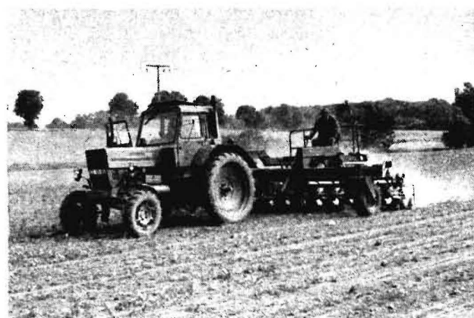
Bild 7. 12reihiger Vereinzlungsautomat 12-JEAN als Anhängegerät zum MTS-80
