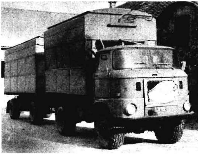
Bild 9 Kombination mehrerer Elemente des Einheitlichen Aufbautensystems (EAS) für den Futtertransport
