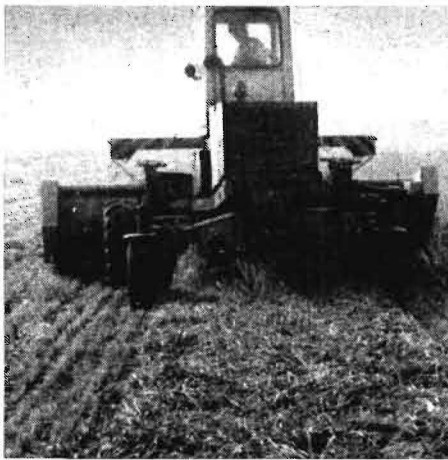
Bild 1. Schwadmäher E 301 mit Rüstvariante zur Breitablage des Mähguts; Ablagebreite 2,70 m
