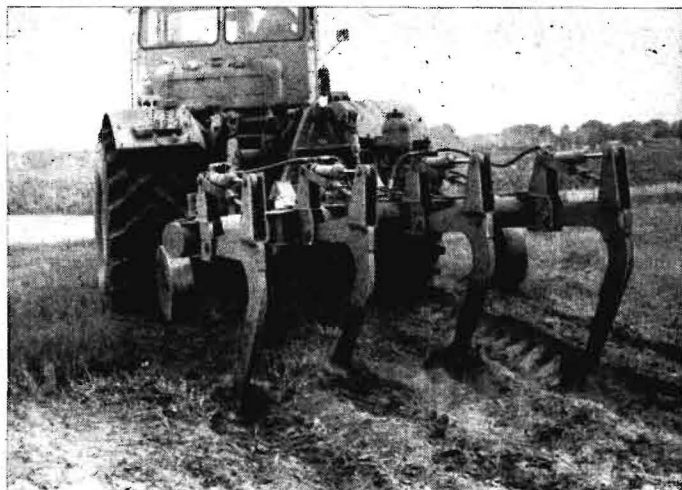
Bild 1 Krümenbasislockerer B 246 A
