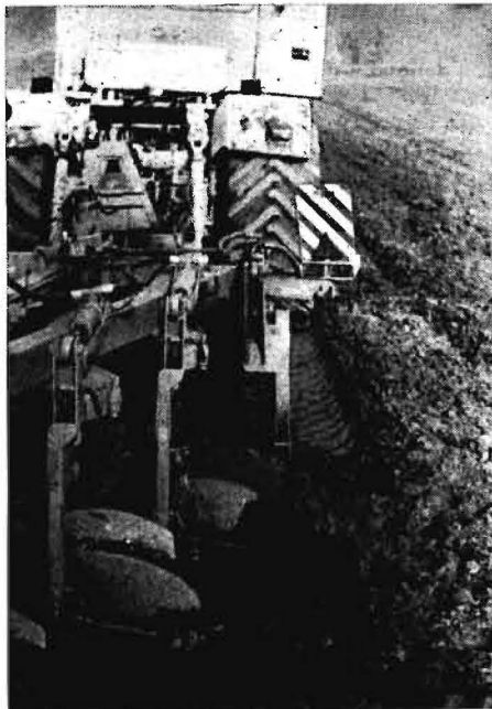
Bild 2. Lockerungszinken am Pflug B 550
