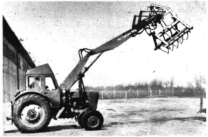
Bild 3. Strohauslagerungsvariante zum Traktor MTS-50
