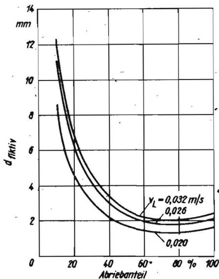
Bild 8. Fiktiver Durchmesser in Abhängigkeit vom Abriebanteil
