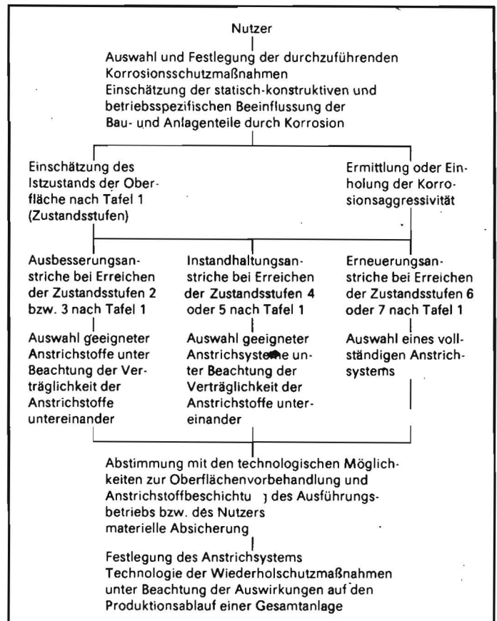
Bild 1 Entscheidungs-kriterien über durchzuführende Korrosionsschutzmaßnahmen beim Erstkorrosionsschutz
