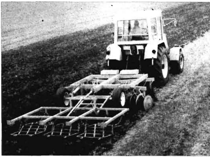
Bild 1. Scheibenegge B 402 A 01 mit Traktor ZT 323
