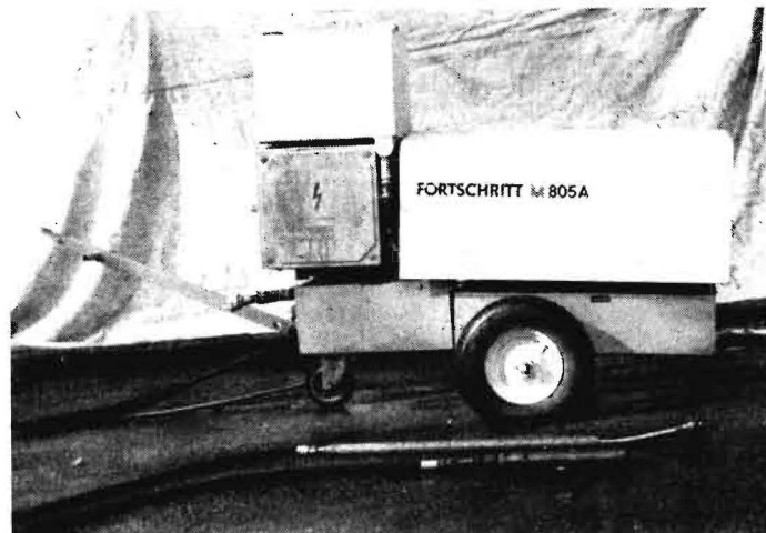
Bild 5. Zusatzgerät zum hydraulischen Verschäumen von Tensidlösungen mit Hilfe des Reinigungsgeräts M 805 A
