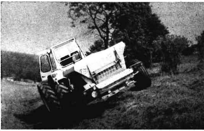
Bild 2. Düngerstreuer RCW-3H am Traktor ZT 305-A beim Einsatz am Hang
