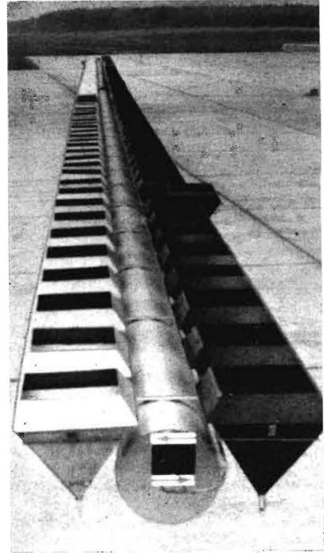
Bild 5. Prüfanlage zur Messung der Streuge nauigkeit von Agrarluftfahrzeugen
