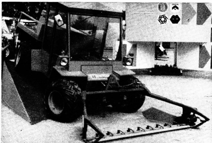
Bild 3. Berg-Kleintraktor MT 6-030 mit Busatis-Doppelmessermähwerk; Motor mit einer Leistung von 33 kW, Arbeitsbreite 2 000 mm, Hangeinsatzgrenze 45°, Reifen Good Year Terra 31 x 15,50-15
