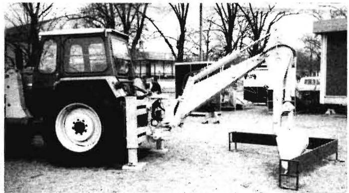
Bilder 1 und 2. Baggerlader macmoter BL 1000 (Italien), für Schiebe-, Planier-, Aushub- und Ladearbeiten einsetzbar; das Gerät wird über einen Hilfsrahmen am Traktor montiert und vom Fahrersitz aus bedient
