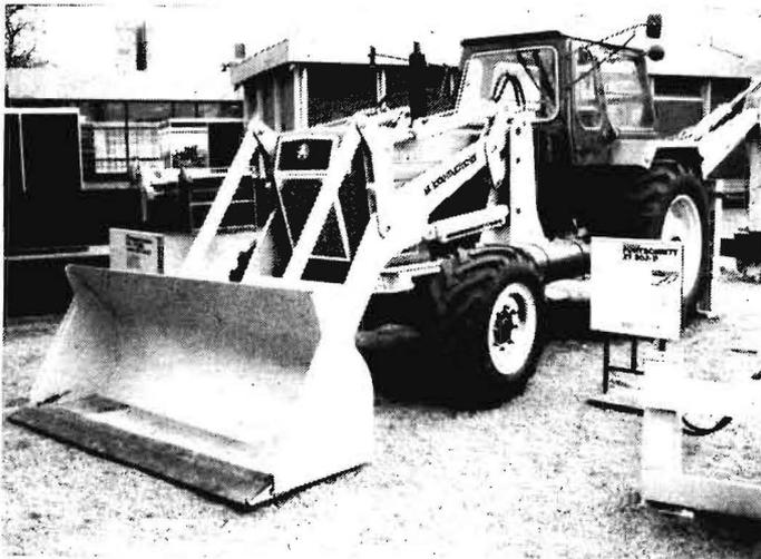
Bild 3. Grabenbagger macmoter 3600 ts (Italien); Anbau an Dreipunktaufhängung, Bedienung vom Fahrersitz oder vom Baggersitz aus; maximale Grabentiefe 3 600 mm, Schwenkbreite 180°, Zusatzgerät Erdlochbohrer
