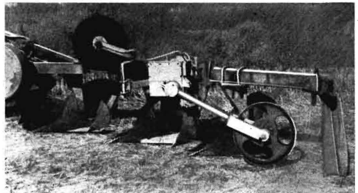
Bild 3 Elektrisch klassierende Tastradmeßeinrichtung zur Pflugtiefmessung am Anbaubeetpflug B 126
