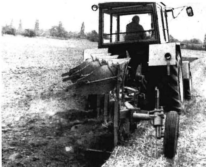
Bild 1. Anbaudrehpflug B 173 A (dreifurchtig) mit Traktor ZT 323
