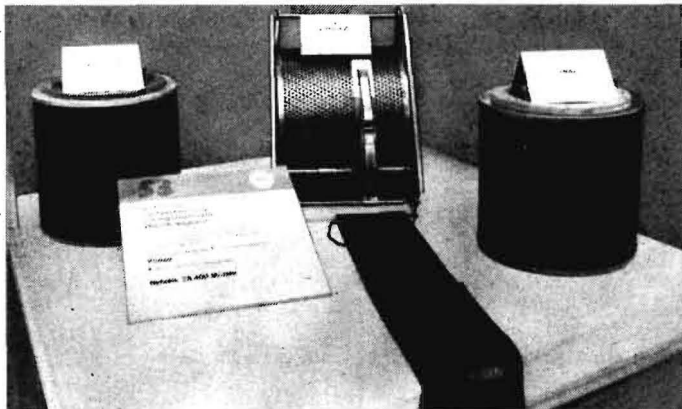
Bild 5 Vorrichtung zur Rege- nerierung von Papierluft- filtern
