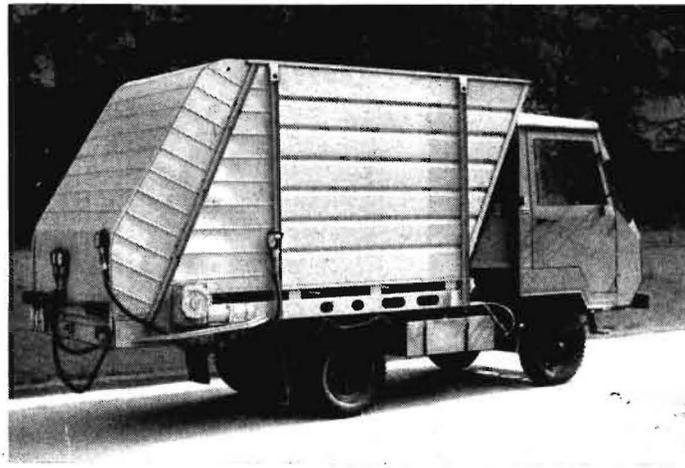
Bild 12. Multicar M25 mit Grobfutterdosier- und -verteilereinrichtung
