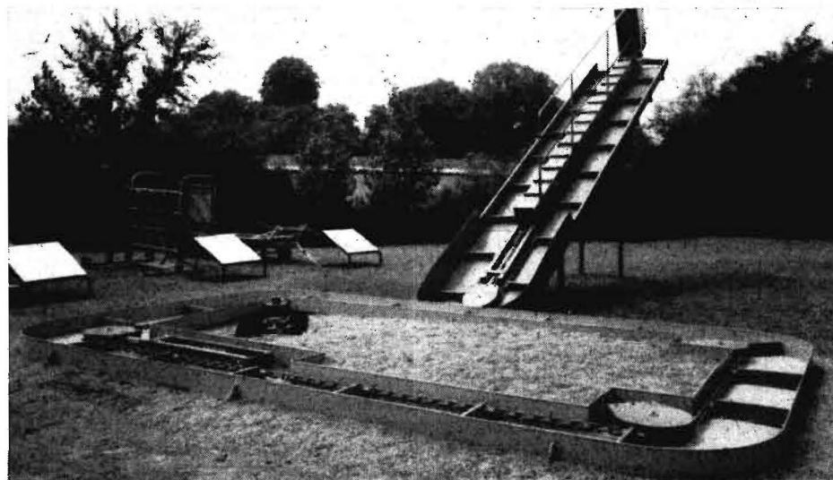
Bild 5. Kratzkettenentmistungsanlage H 870 für die stationäre Entmistung in der Rinder- und Schweineproduktion
