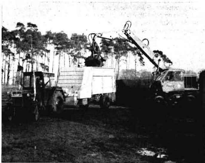
Bild 2. Der Futterverteilwagen L 431 war der erste der Typenreihe mobiler Futterverteiler für die Rinderproduktion
