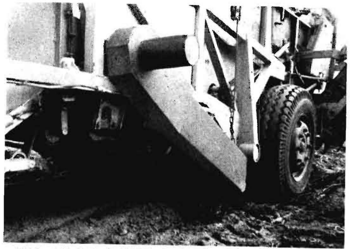
Bild 6. Anordnung der Einebnungsschnecke und ihres Antriebs
