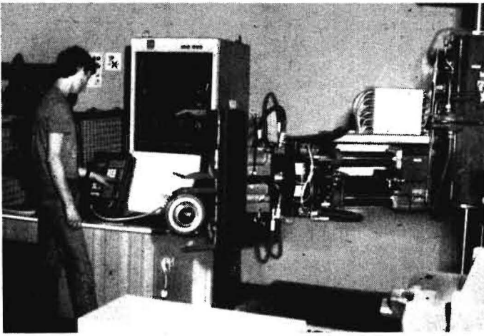
Bild 1. Programmeingabe für die Beschickung einer Drehmaschine
