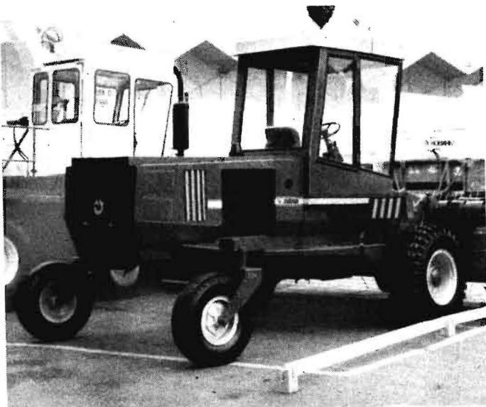
Bild 1. Selbstfahrender Feldhäcksler „Slawjanka“ SWSch-4,0 mit hydrostatischem Einzelradantrieb und Lenkung über Drehzahlsteuerung der Antriebsräder
