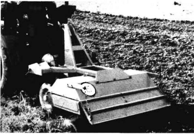
Bild 3. UT 082 mit Bodenfräse (1 m Arbeitsbreite) aus der VR Polen 2
