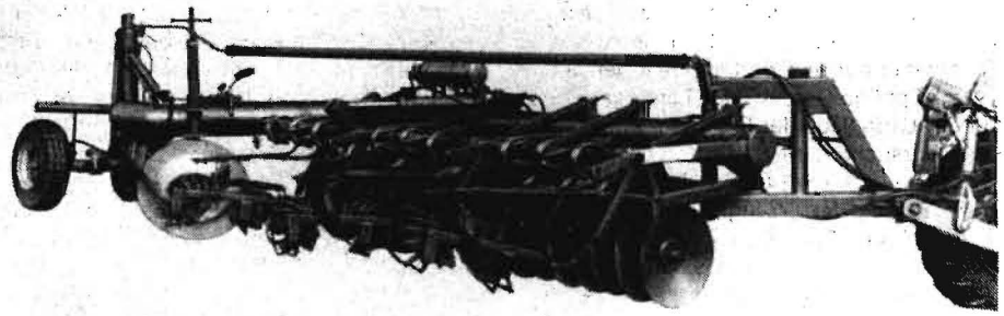
Bild 1. Scheibenschälflug PH 2-020 in Arbeitsstellung
