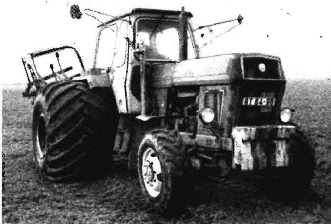
Bild 3 Untersucht wurde auch die Wirkung von Reifenverbreiterungen am ZT 303 mit Niederquerschnittsreifen (Breite 1200 mm)
