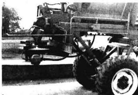
Während der anschließenden Feldvorführung wurde den Experten die Leistungsfähigkeit der Streuer, die z. T. schon eine mehrjährige Erprobung bestanden hatten, demonstriert. Zu sehen waren auch Versuchsmuster der Übergabeeinrichtungen T 013 und T 014 (Bild 4), die zur Beschickung der Mineraldüngerstreuer eingesetzt werden.
