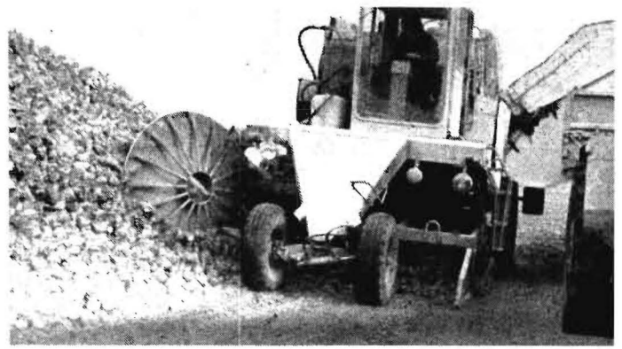
Bild 5. Reinigungslader KS-6 Oschersleben
