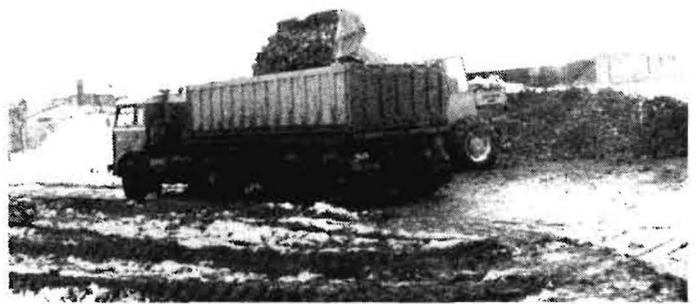
Bild 4. Zuckerrübenabfuhr von einem mit Baustraßenmatten stabilisierten Lagerplatz
