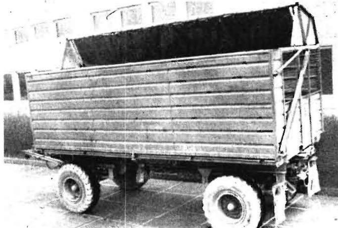
Bild 3. Anhänger HW80.11/EAS5 für den Transport von Grün- und Welkgut, Stroh und Heu
