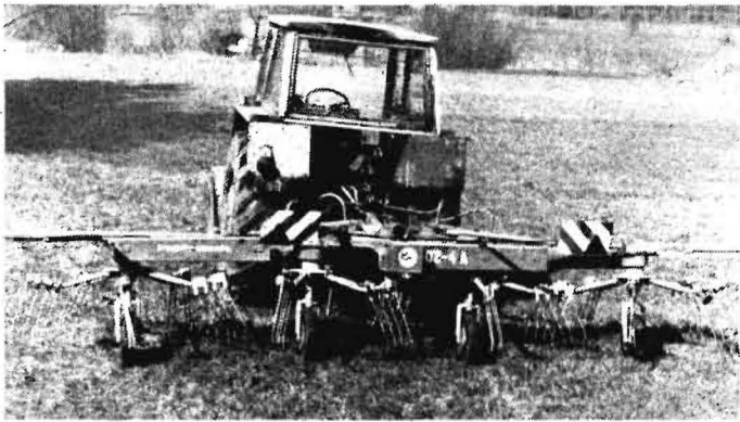
Bild 5. Rotorwender OZ-4A in Arbeitsstellung; Hersteller: Agrozet Rožmital... pod Třemšínem
