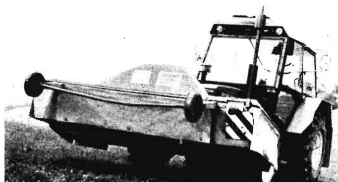
Bild 7. Scheibenmäswerk SP2-201 (Frontanbau); Hersteller: Agrozet Pelhřimov
