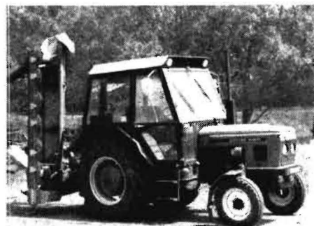
Bild 4 Scheibenmäherwerk SP9-061 mit Schwadbearbeitung; Hersteller: Agrozet Pelhřimov
