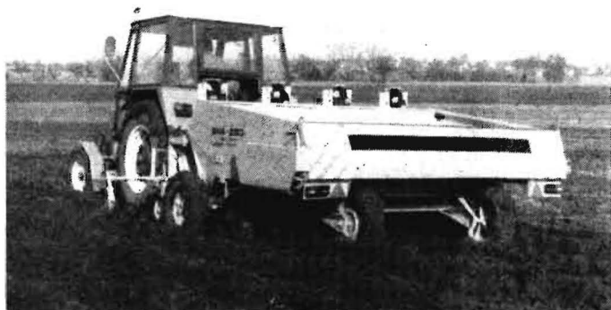
Bild 3 Legemaschine für vorgekeimte Kartoffeln SK 4-290; Hersteller: Agrozet Prostějov
