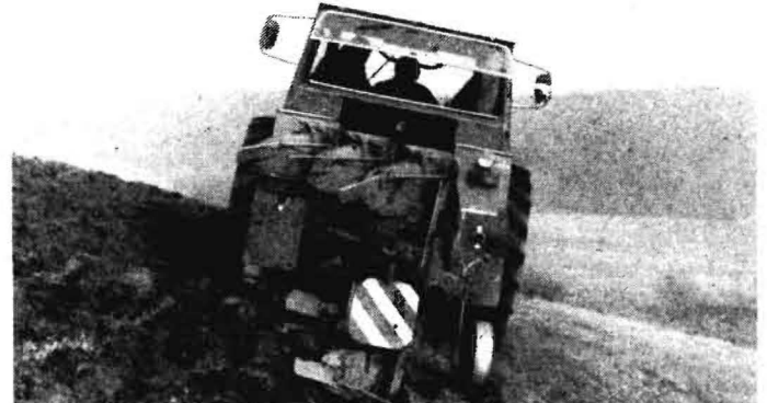
Bild 8. Drehflur für Hanglagen PH1-441, dreischarig; Hersteller: Agrozet Roudnice
