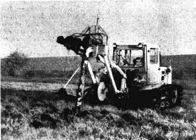
Bild 2. Werkzeugerstellung und Arbeitsorgan des Maulwurffräsdräners
