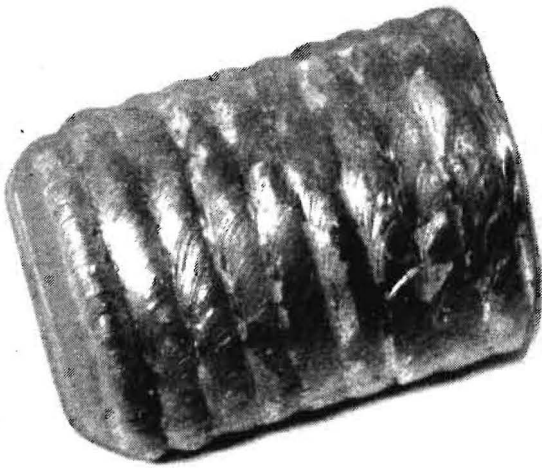
Bild 2. Oberfläche eines einlagig aufgeschweißten Bauteils
