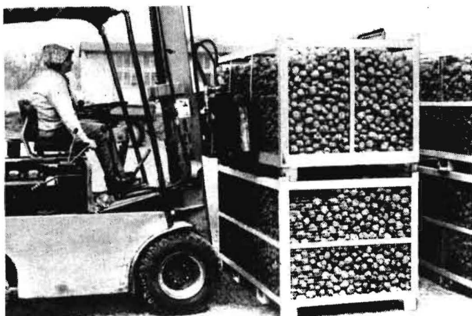
Bild 2 Behälter für Pflanzkartoffeln T922-D mit standardisierten Außenabmessungen in zwei verschiedenen Ausführungen der Seitenteile
