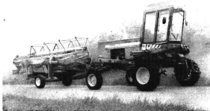
Bild 1. Schwadmäher E 303 mit Rapsschneidwerk E 327 in Transportstellung
