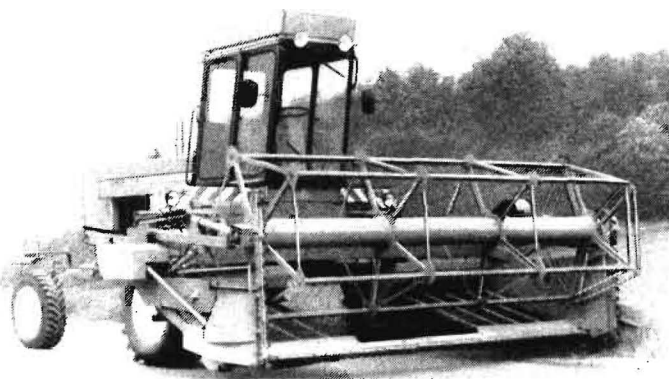
Bild 2. Schwadmäher E 303 mit Rapsschneidwerk E 327 in Arbeitsstellung
