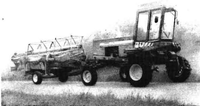
Bild 2. Schwadmäher E 303 mit Rapsschneidwerk E 327 in Arbeitsstellung
